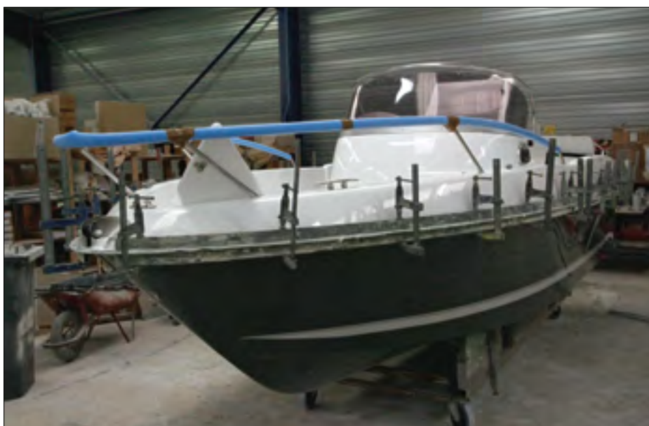
Assemblage de la coque et du pont d'un 552 Open : le collage est effectué avec une résine armée qui se polymérise pendant plusieurs heures.
