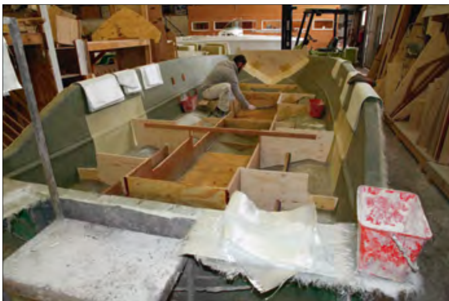
Une imposante ossature en contreplaqué vient rigidifier la coque de tous les modèles. La construction en stratifié de polyester est réalisée entièrement à la main.
